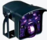
雷达/红外感应器 通过雷达感应物体的移动, 通过红外感应物体的存在, 从而快速准确的实现自动开门, 可靠的保护功能, 最大安装高度为6 m。在潮湿环境以及室外环境, 仅雷达功能起作用 壳体防护等级: IP 65
