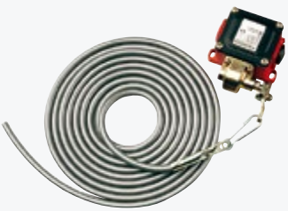
拉绳开关 可以水平或垂直安装, 铸铝壳体, 防护等级: IP 65 拉绳长度为 4 m
